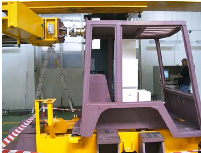
Сл.5 Приказ испитивања заштитне кабине у лабораторијским условима
